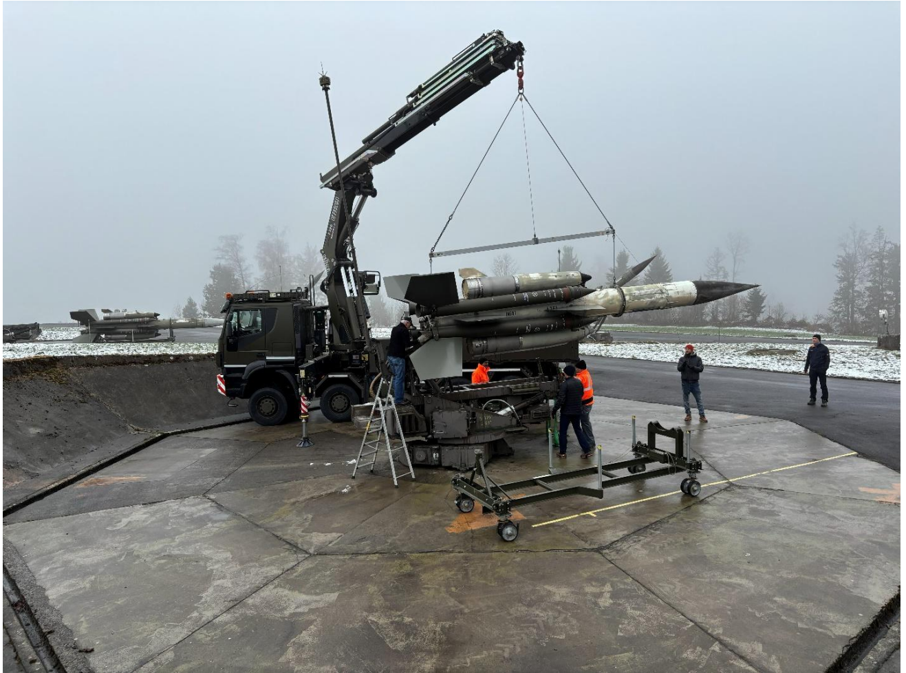
Abbildung 5: Laden der Lenk Waffen mit einem Kran (17.03.2025)
