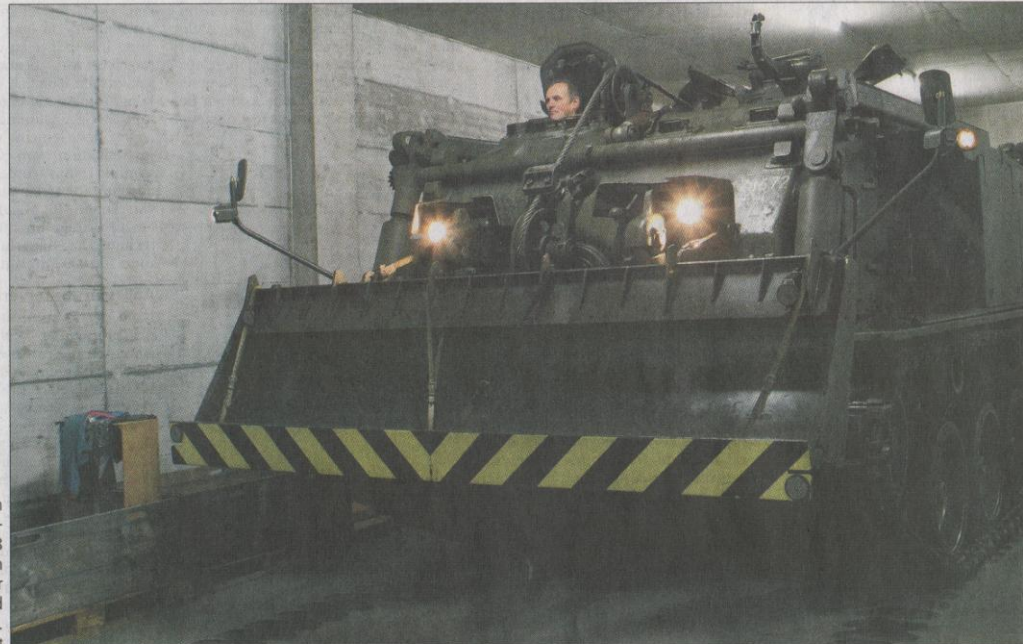
Mit dem Entpannungspanzer 65/88 wurden defekte Panzer vom Feld geborgen. Bild Werner Schelbert
